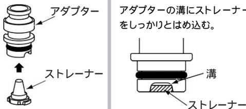
**6** アダプターを電磁弁に取り付け、ストップリングを取り付け、吐出管に接続する。
