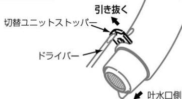
切替ユニットストッパーは、片側にドライバーなどで取り外すための溝があります。ドライバーを溝に掛けて取り外してください。
